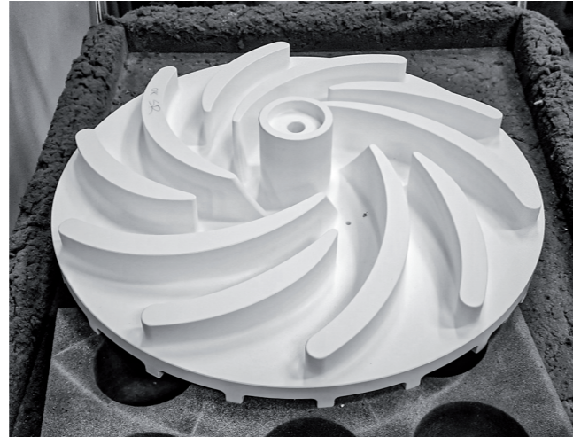
KERAMIKLAUFRAD Vorderseite vor Endbearbeitung
